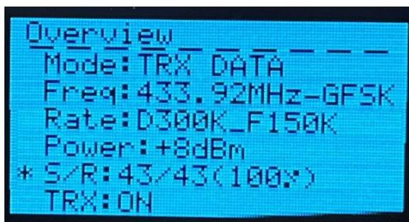
**说明：**当“TRX: ON”时，可对 S/R 计数值进行清零并重新计数。如对其他参数进行设置，TRX DATA 功能自动关闭，“TRX: OFF”。
