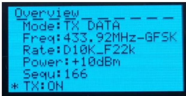
**说明：**当“TX: ON”时，可对 sequ 计数值进行清零并重新计数。如对其他参数进行设置，TX DATA 功能自动关闭，“TX: OFF”。
