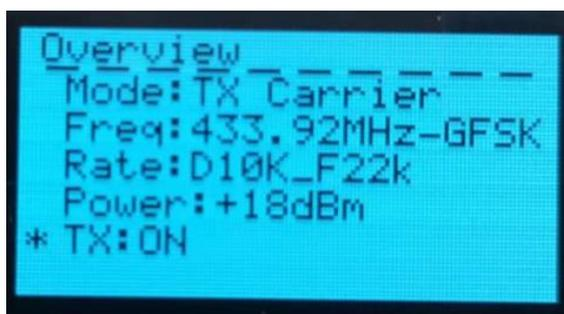
**说明：**当“TX: ON”时，如对其他参数进行设置，TX Carrier 功能自动关闭，“TX: OFF”。
